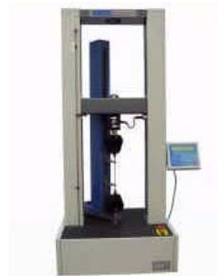
EX800Plus 安装在双柱材料试验机
