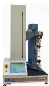
EX250Plus 安装在单柱材料试验机
