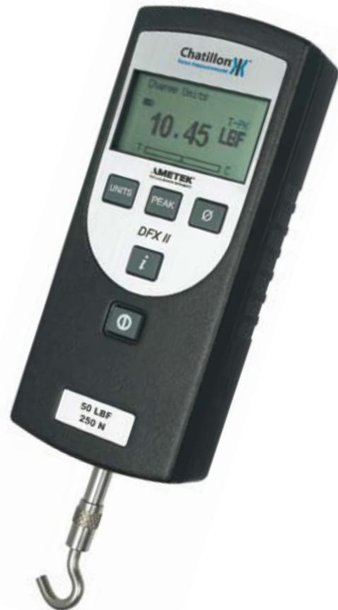
CHATILLON® DFX 系列是基本峰值测量最为经济的数显测力计。DFX系列可提供四种负载量程 (10 lbf、50 lbf、100 lbf、200 lbf), 并拥有内置传感器, 测量精度优于满量程的0.3%。DFX 系列使用充电镍氢电池组, 也可以使用随机的通用电源适配器, 并提供美国、欧洲、英国标准的电源插头。在电池供电状态下, DFX 系列可连续使用70至100小时。DFX 系列采用高清晰的点阵式大液晶屏, 能支持各种类型的标准测试功能, 包括标准和峰值读数等。载荷显示单位为: N, lbf, gf, kgf 和ozf。显示语言可设置为英语、西班牙语、法语、德语、葡萄牙语和中文。DFX 系列测力计设置菜单中包含校准程序。与 DFX 系列测力计一同提供的有手提箱、通用电池充电器、平面及钩型接头, 也可以选择带有 NIST数据的校准证书。
